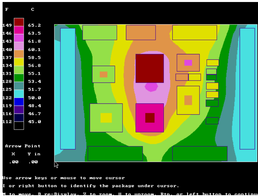
Fig. 8 Hartă termică obținută în urma simulării
